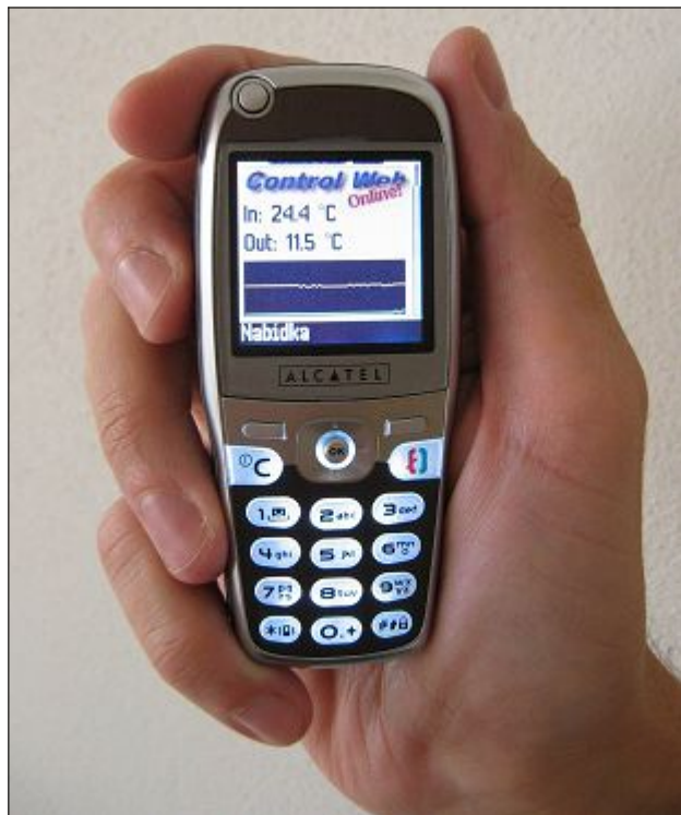
Obrázek 1 WWW prohlížeč zobrazující stránku generovanou HTTP serverem systému Control Web prostřednictvím rozhraní GPRS
